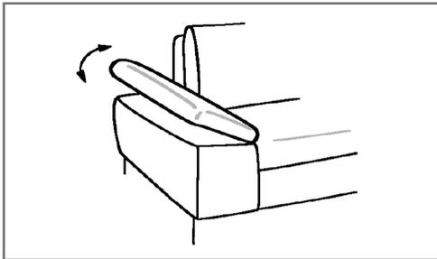
Armteil mit Rasterverstellung in allen Elementen mit Armlehne A möglich, in der Type nur komplett möglich, nicht möglich im Sessel.
