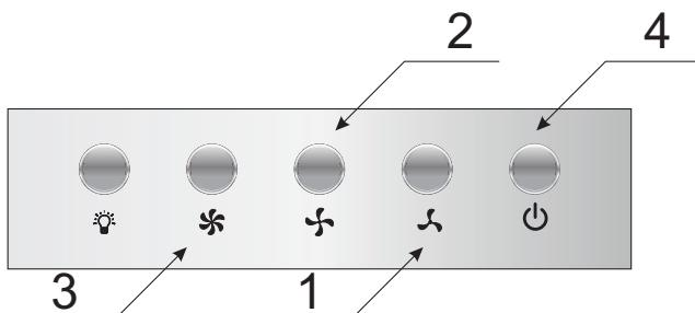
Het bedieningspaneel is uitgerust met knoppen (isostat). Schakel de afzuigkap in door een van de hieronder beschreven snelheden te kiezen en de betreffende knop in te drukken:
