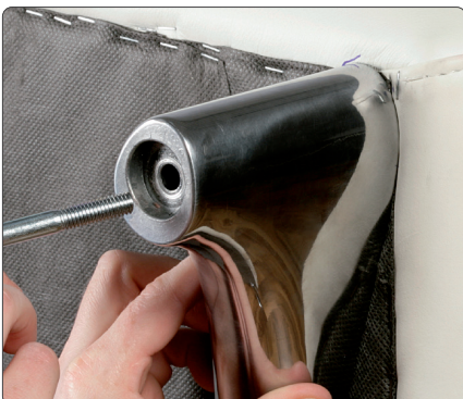
Fuß aufsetzen und mit der langen Sechskantschraube fixieren
