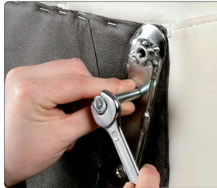
kurze Sechskantschrauben an gleicher Position anschrauben
