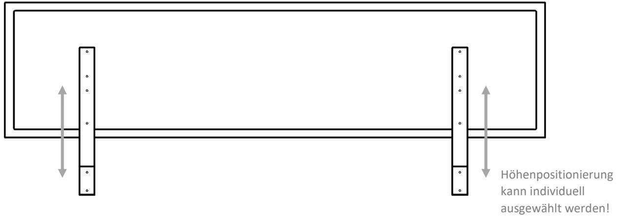
**Hinweis!** Jede Kopfteilhalterung wird mittels zwei Spax-Schrauben am Kopfteil befestigt.
