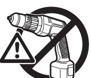
Die Muttern anziehen, bis sie fest anliegen. Dann um eine Vierteldrehung weiterdrehen. NICHT ÜBERMÄSSIG FESTZIEHEN.
