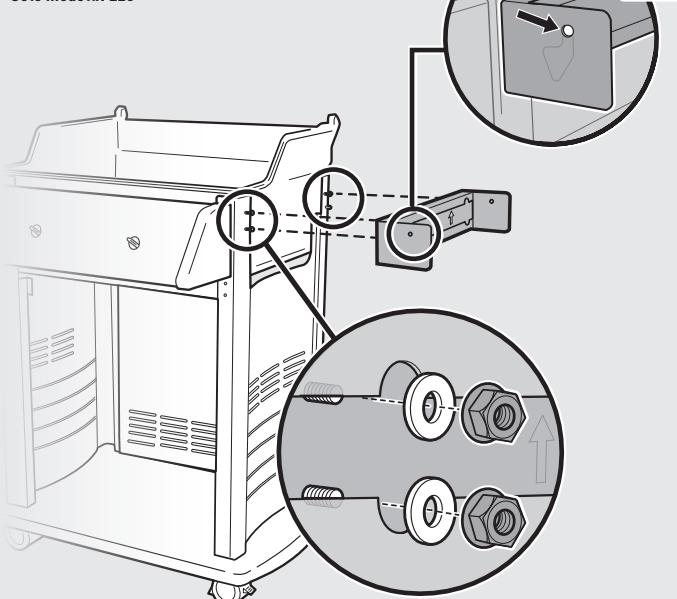
Draai de moeren handvast. Draai ze vervolgens nog een kwartslag. NIET TE STRAK VASTDRAAIEN.
