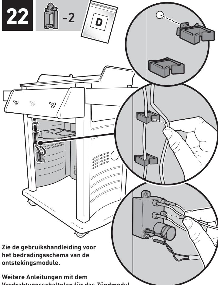
Zie de gebruikshandleiding voor het bedradingsschema van de ontstekingsmodule.
