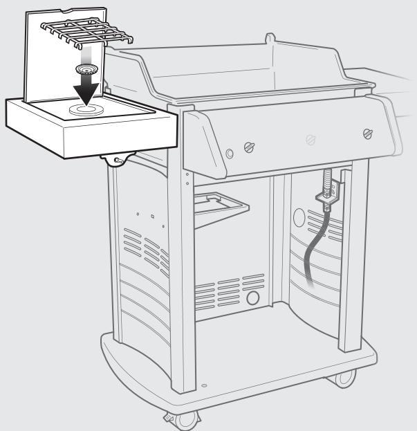
Draai de moeren handvast. Draai ze vervolgens nog een kwartslag. NIET TE STRAK VASTDRAAIEN.
