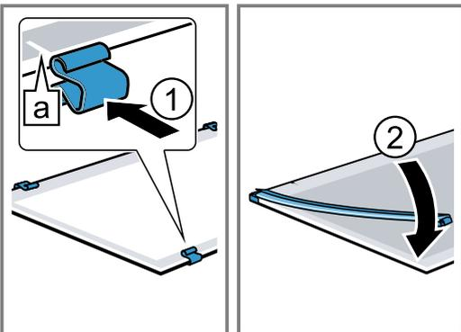
3. Die Zwischenscheibe mit Abstandshalter und Dichtungen in Pfeilrichtung einsetzen **①**.
