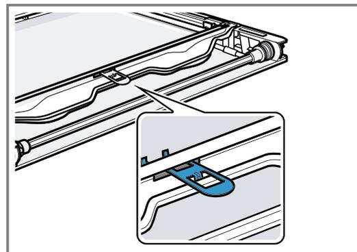
6. Die Innenscheibe so auf die Gerätetür legen, dass die Nummer **a** rechts unten lesbar ist. Die Innenscheibe schräg nach hinten in die Befestigungschiene **b** einsetzen.
