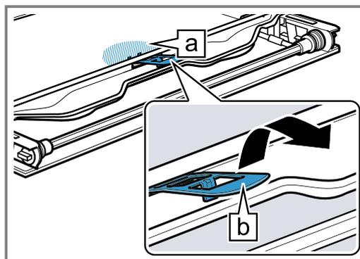
6. Die erste und zweite Zwischenscheibe von unten anheben ① und in Pfeilrichtung herausnehmen ②.
