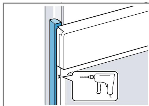
3. Gerät mit adäquater Schraube befestigen.
