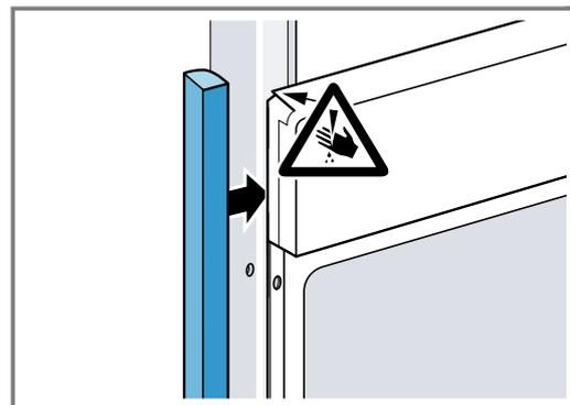
2. Aluprofile vorbohren, um eine Schraubverbindung herzustellen.
