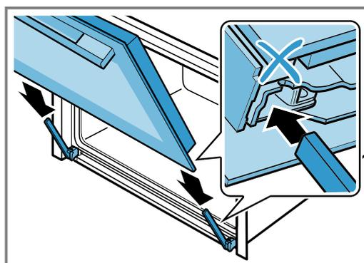
2. Mit beiden Händen von oben links und rechts auf die Türabdeckung drücken, um zu prüfen, ob die Gerätetür bis zum Anschlag eingeschoben ist.
