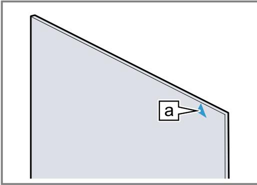
2. Die Zwischenscheibe unten in die Halterung **a** einsetzen **1** und oben andrücken und festhalten.
