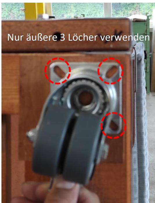
Schrauben Sie mit den mitgelieferten Schrauben die Fahrrolle durch das Brettchen in die Holzleisten.
