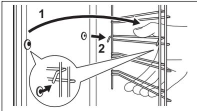
4. Setzen Sie die Einhängegitter in umgekehrter Reihenfolge ein. Die Haltestifte an den Teleskopplüfern müssen nach vorne zeigen.
