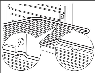
Schieben Sie den Rost zwischen die Führungsstäbe der Einhängegitter. Stellen Sie sicher, dass der Rost die Rückseite des Garraums berührt.
