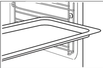
Schieben Sie das Backblech zwischen die Führungsstäbe der Einhängegitter. Platzieren Sie das Backblech mit Gefälle zur Rückseite des Backofinnenraums.
